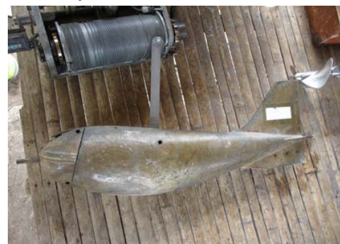
ง) เครื่องมือเก็บตะกอนแขวนลอย รุ่น US D-49
